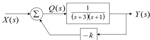
解: 如图设辅助函数  $Q(s)$ , 则由加法器可知:  $Q(s) = X(s) - kY(s)$ 。
