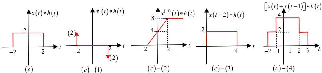
2-23 已知系统的微分方程为  $y''(t)+3y'(t)+2y(t)=x'(t)$ ，试求系统在下列激励作用下的零状态响应。
