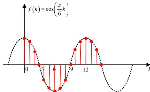
**1-5** 已知虚指数信号  $f(t) = e^{j\omega_0 t}$ , 如果对  $f(t)$  以抽样间隔  $T_s$  进行均匀抽样得离散时间序列
