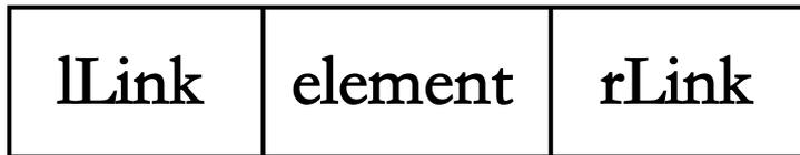
双向链表的每个结点的结构具有如下定义的结构类型：
