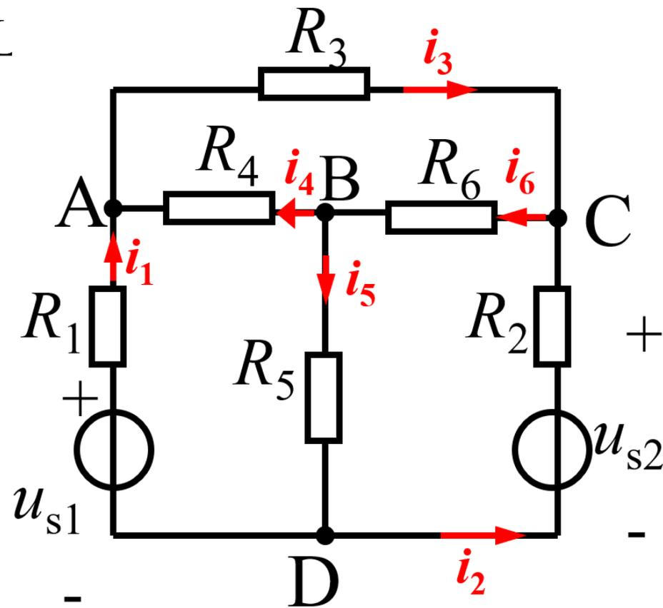
结论：一般来讲，具有  $n$  个节点的电路，只能列出  $(n-1)$  个独立的KCL方程。
