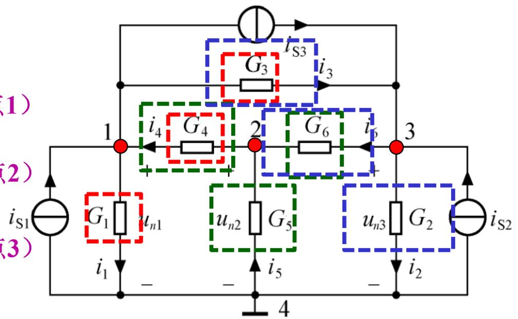
$G_{ii}$ —自电导，等于连接在对应节点上所有支路的电导之和，取正号。
