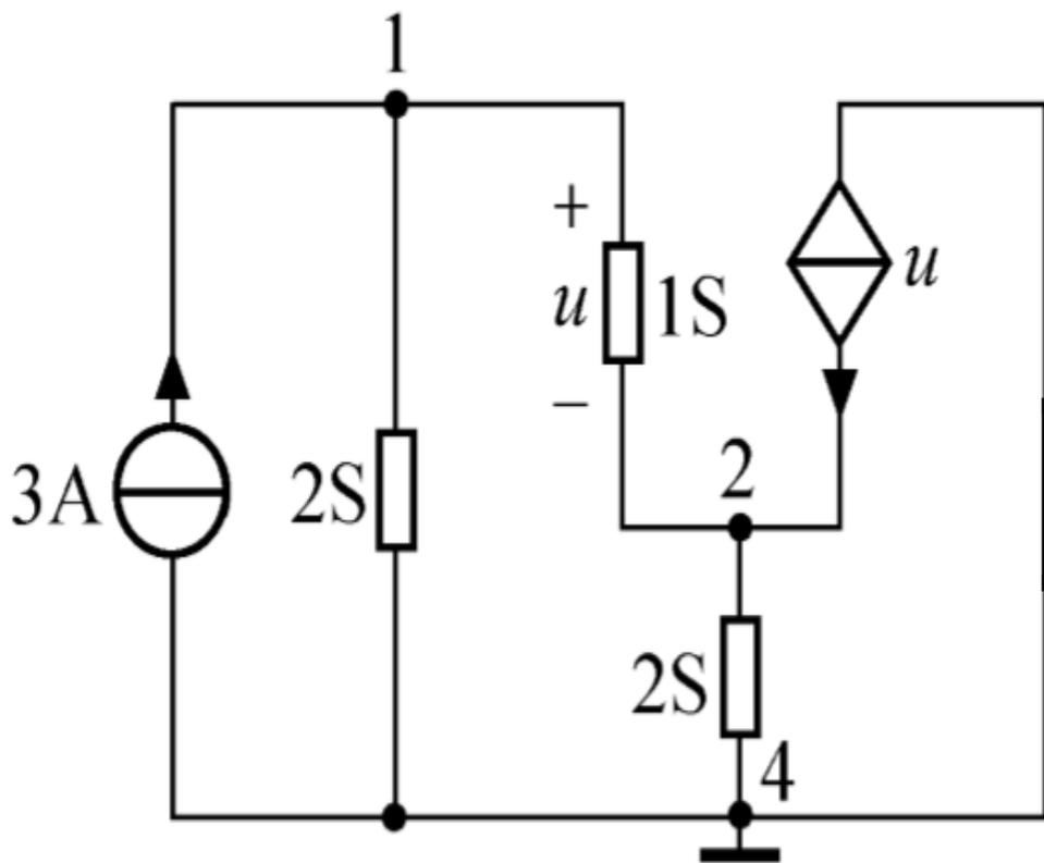
与（受控）电流源相连的电导不能计入自电导和互电导。
