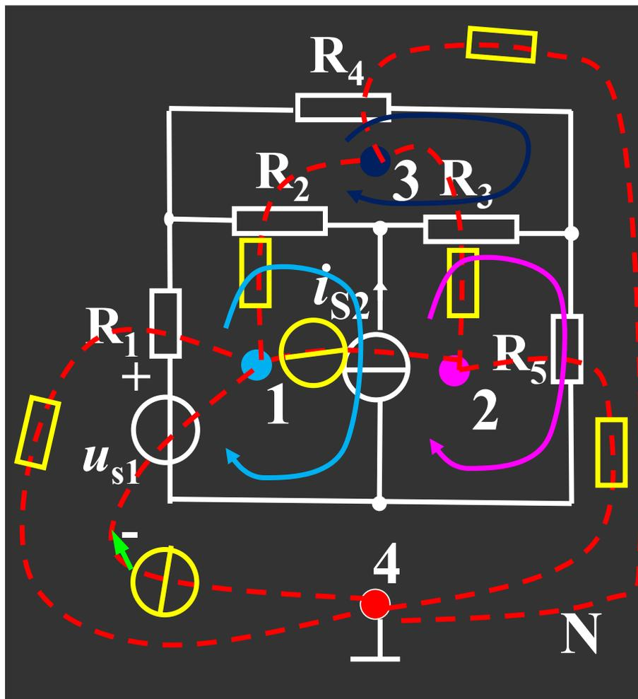
**N**中的电流源：若与该网孔方向一致，则**N'**中电压源正极与该网孔所对偶的节点相接，不一致接负极——2接+，1接-
