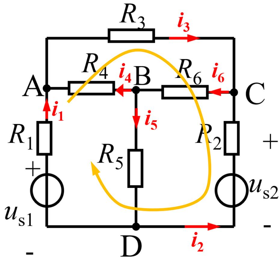
4个节点，6条支路的电路。可列3个独立KVL方程。
