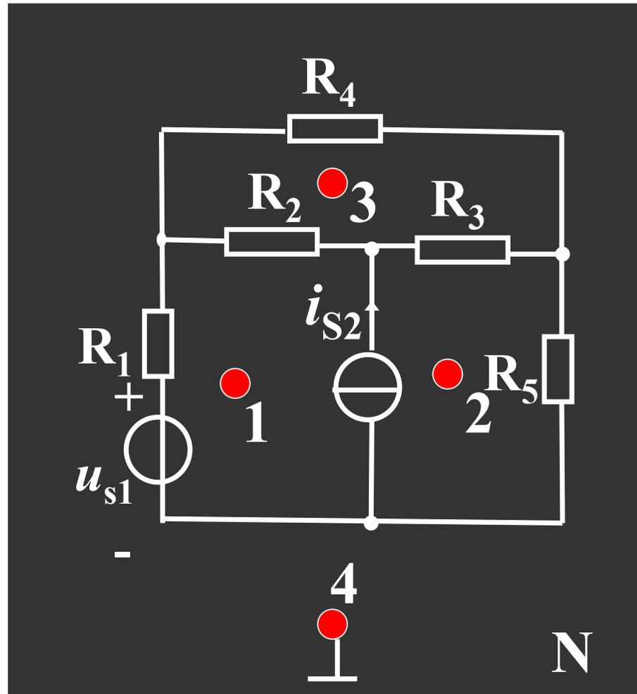
(2) 穿过N的每个元件，用虚线将节点联起来，表示N'的一个支路，其元件是N中穿过元件的对偶元件
