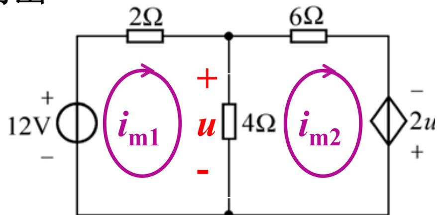
列辅助方程, 将受控源的控制量  $u$  用网孔电流表示  $u = 4(i_{m1} - i_{m2})$
