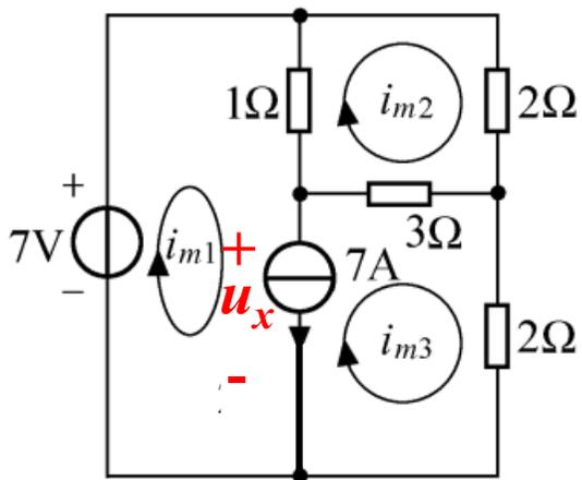
解一：设电流源两端电压为 $u_x$ ，参考方向如图所示。
