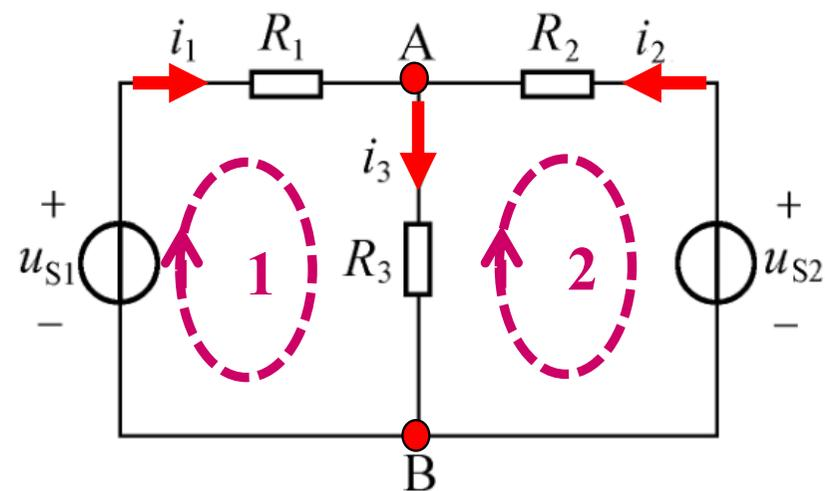
【例】已知电路如图所示，试用支路电流法分析各支路电流和支路电压 $u_{AB}$ 。
