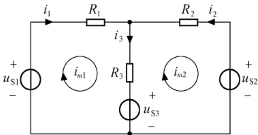
解： (1) 设网孔电流  $i_{m1}, i_{m2}$
