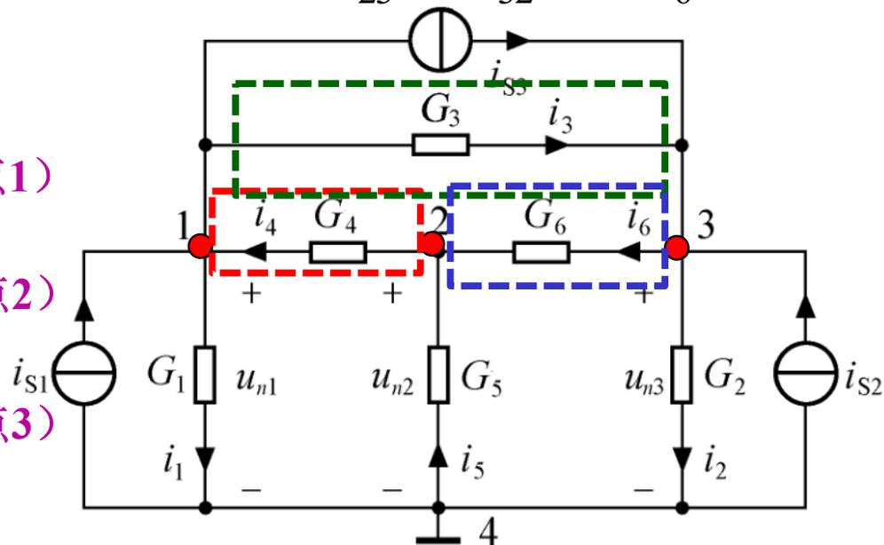
$G_{ij}$ —互电导，对应两节点相连的所有支路的电导之和，取负号。
