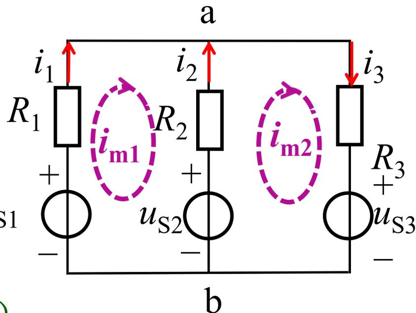
电压源沿着网孔电流方向电压升为正，降为负
