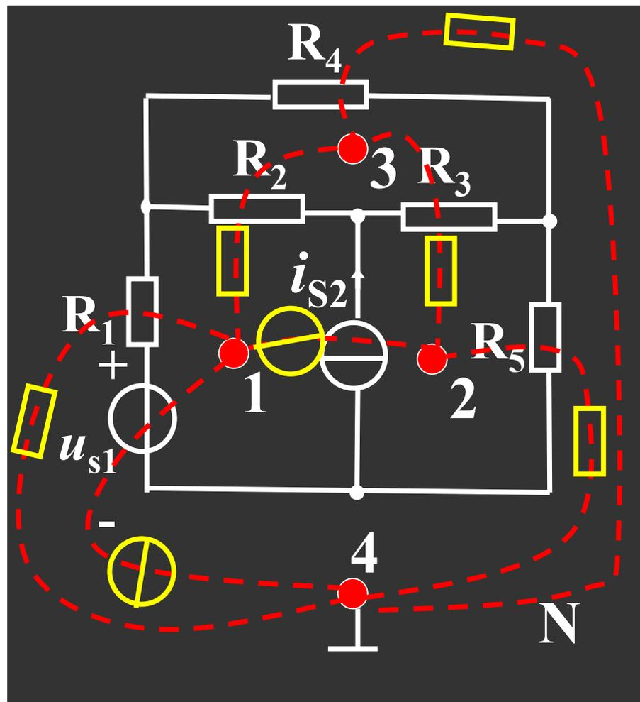
3) 电源极性： 设N网孔方向取顺时针。
