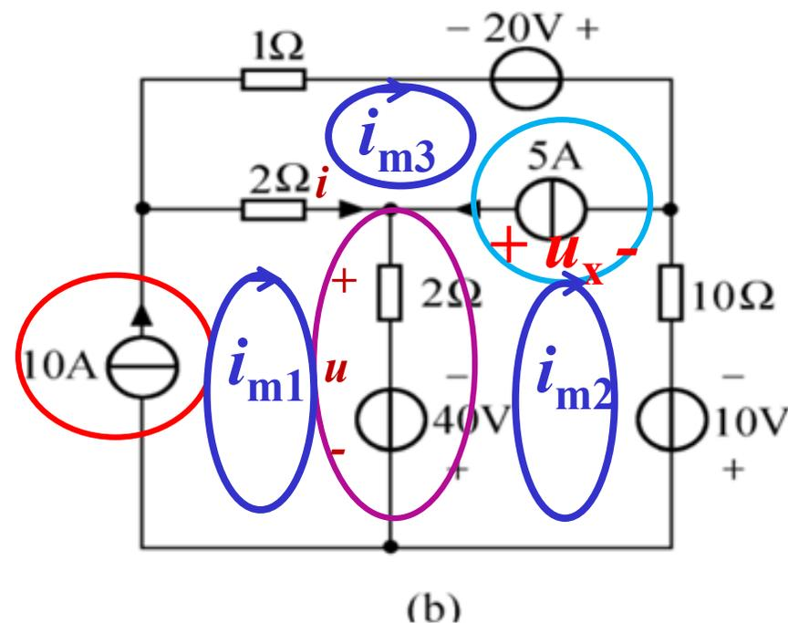
解：  $i_{m1}$  的方向与该10A电流源方向相同。
