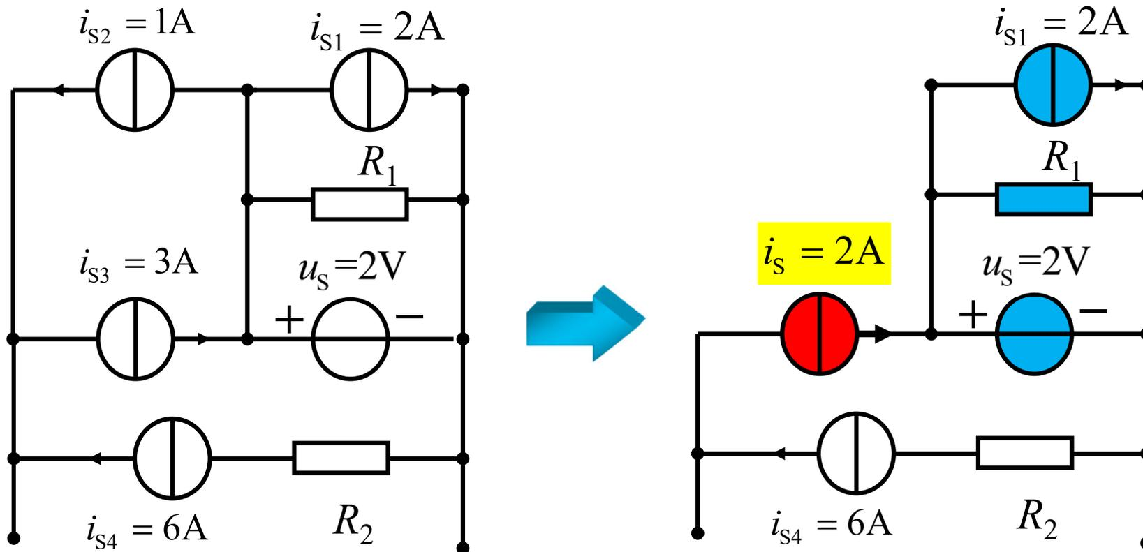
**【例】**（P35例2-7）将下图等效简化为一个电压源或者电流源。
