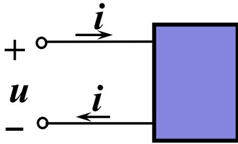
端口由一对端子构成，且满足从一个端子流入的电流等于从另一个端子流出的电流。
