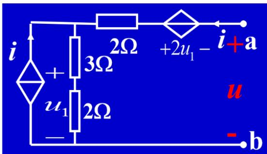
解：端口加电压  $u$  .列端口VCR
