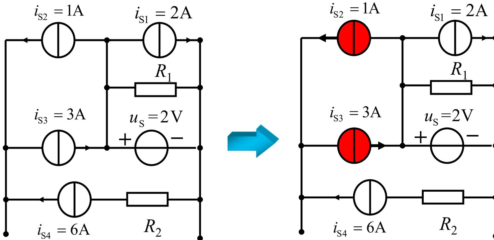
【例】（P35例2-7）将下图等效简化为一个电压源或者电流源。
